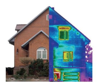
micos, contenido de humedad y filtración de aire. Dos fuentes principales de pérdidas de calor en los edificios son las conducciones en los muros y las filtraciones de aire. Localizan los puentes térmicos mediante colores, detectando la zona infrarroja del espectro electromagnético.
